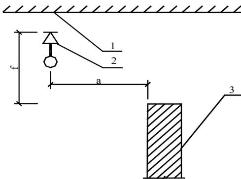
图 7.2.4 喷头与不到顶隔墙的水平距离
