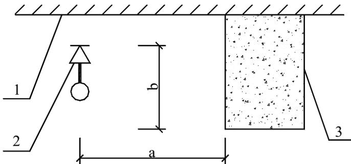
图 7.2.1 喷头与梁、通风管道的距离
