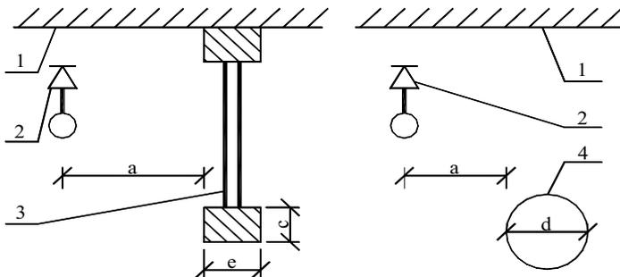
图 7.2.2 喷头与邻近障碍物的最小水平距离
